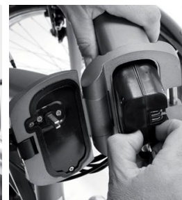
2 – Eteindre le système et enlever la batterie
