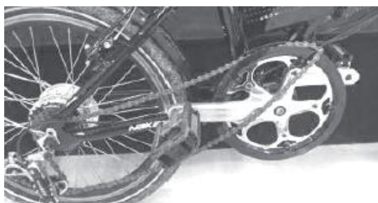
3 – Mettre la chaîne sur le haut du plateau, puis tourner la manivelle vers l'avant
